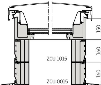
Flachdach-Fenster CVU/CFU mit Aufsetzkränzen ZCU 0015 und ZCU 1015
