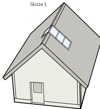
Kombination von 2 Fenstern über den First mit 1 Firsthauben-Set
